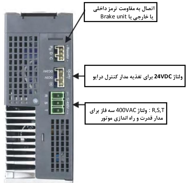
سوکتهای بالای درایو سری 400VAC
