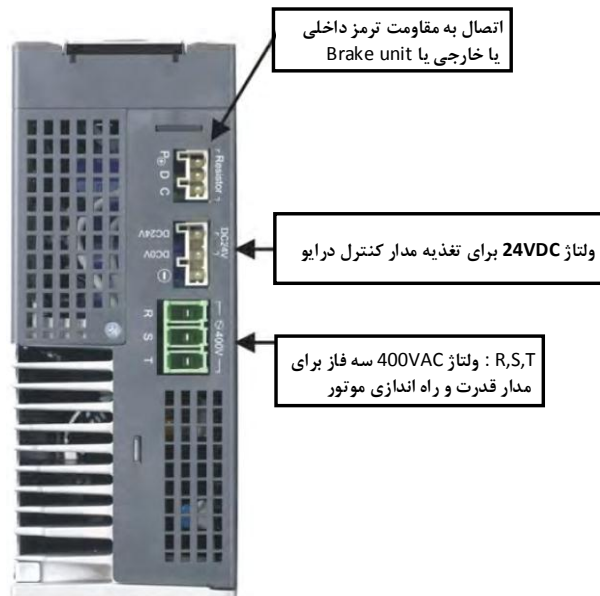
سوکتهای بالای درایو سری 400VAC
